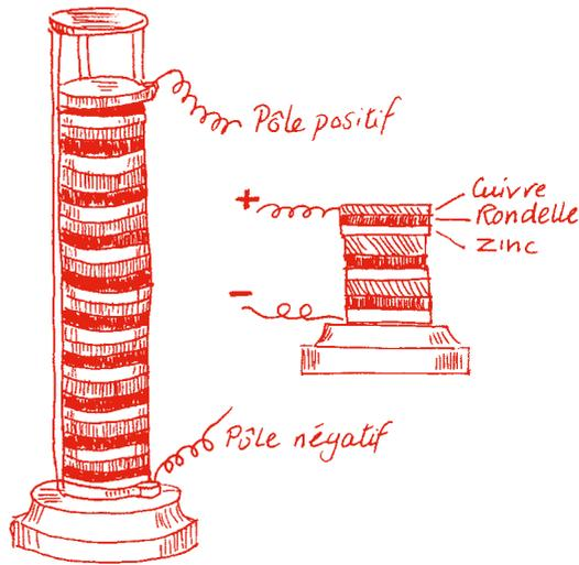
Fig. 283 - Pile de Volta.
